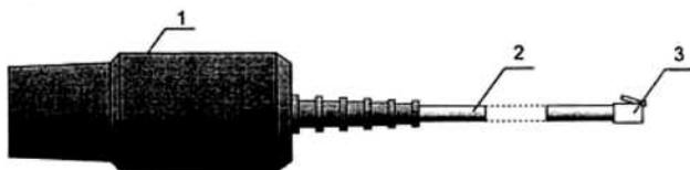
Рис. 11 - Датчик второго компонента (Xe, N<sub>2</sub>O, He).
