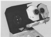
Рис. 13 Призмный компенсатор, установленный в аппарате
