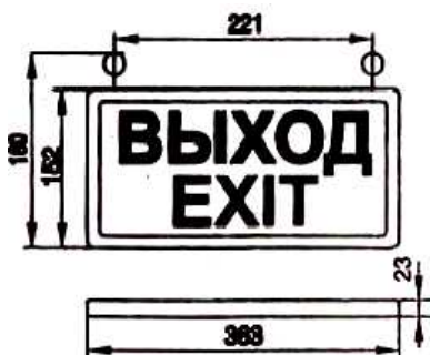
Рисунок 2. Габаритные размеры светильников ССА
