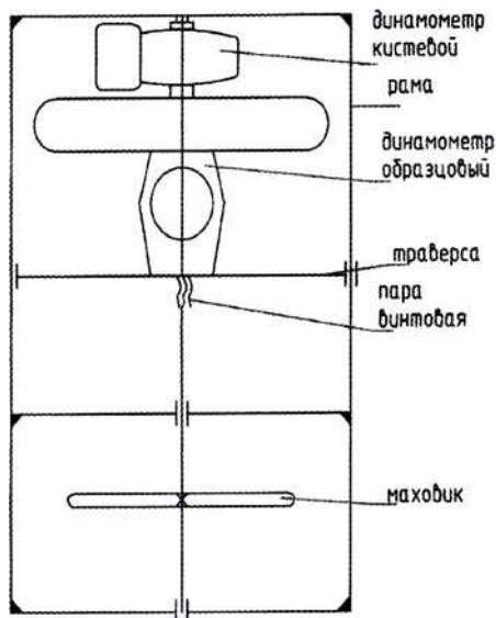
2. Нагружающее устройство представляет собой приспособление, состоящее из рамы, винтовой пары, маховика, траверсы.
