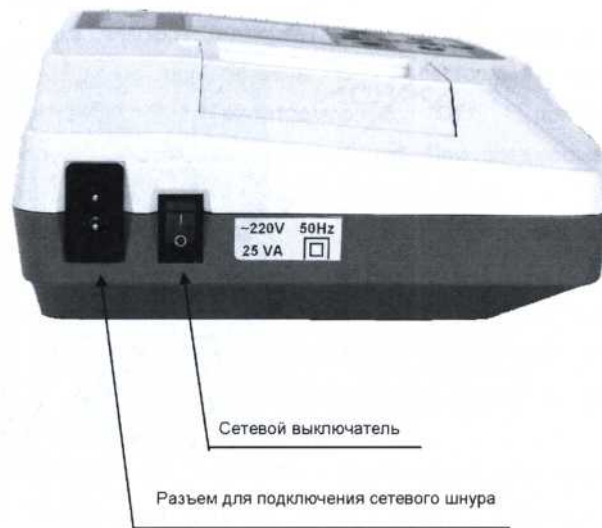
Рисунок 3 - Электрокардиограф (вид слева)
