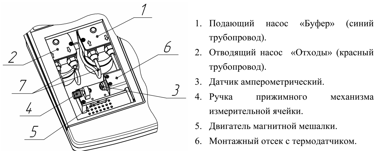
Рис.10. Вид рабочей секции анализатора (со снятой ячейкой).
