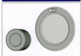
■ Система фильтрации технологических растворов двухступенчатая. Фильтры выполнены из титановой сетки с размерами ячеек 0,5 и 0,01 мм. Они надежно защищают функциональные каналы эндоскопа от засорения белковыми остатками, солиями и т.д.
