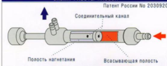
■ Ручной насос предназначен для подачи растворов в функциональные каналы эндоскопа. Насос выполнен из нержавеющей стали, химически стойкой резины и фторопласта. Конструкция исключает появление пузырьков воздуха в нагнетаемой струе, что обеспечивает гарантированное качество дезинфекции и стерилизации каналов эндоскопа.
