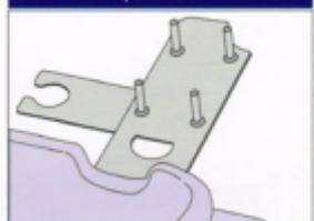
■ Кронштейн установки обеспечивает надежное фиксирование эндоскопа и плавный переход его погруженной части в анатомическую ванну.
