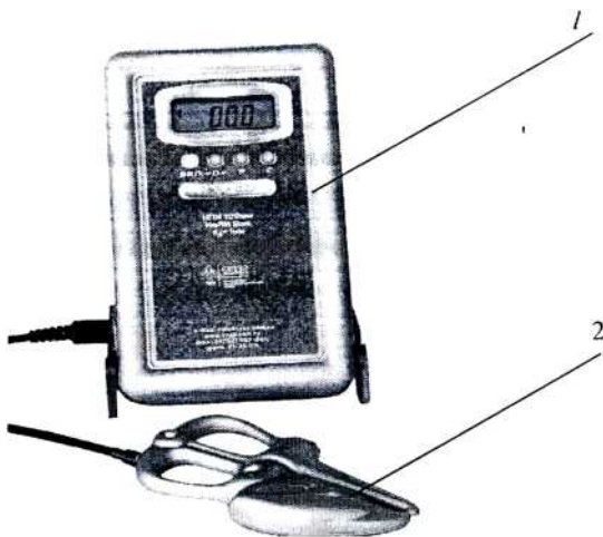
Рис. 1 Внешний вид калипера : 1 - блок управления, 2-калипер.
