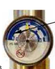
верхняя граница области с нулевой отметкой Рисунок 19 - Манометр на редукторе баллона
