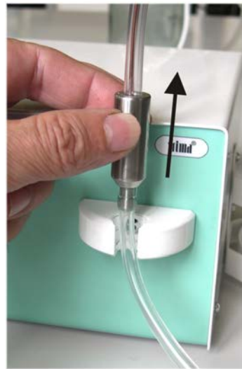
Рис.4. Расположение оптоэлектронного датчика и иллюстрация его срабатывания.
