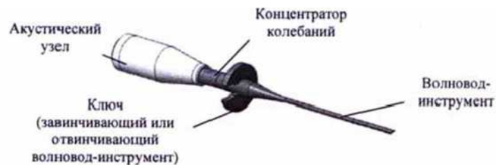
Рисунок 5 - Схема подсоединения или отсоединения волновода-инструмента
