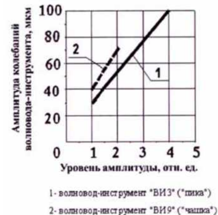
Рисунок А.1 - Зависимость амплитуды колебаний излучающего торца волновода-инструмента от значений показаний индикатора
